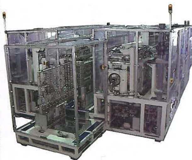
〈液晶パネル市場には欠かせない偏光板貼付機〉
